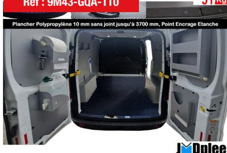
**VITO COMPACT-Kit + Portes Ar Plancher Antidérapant Polypropylène Light 1 Plc**
